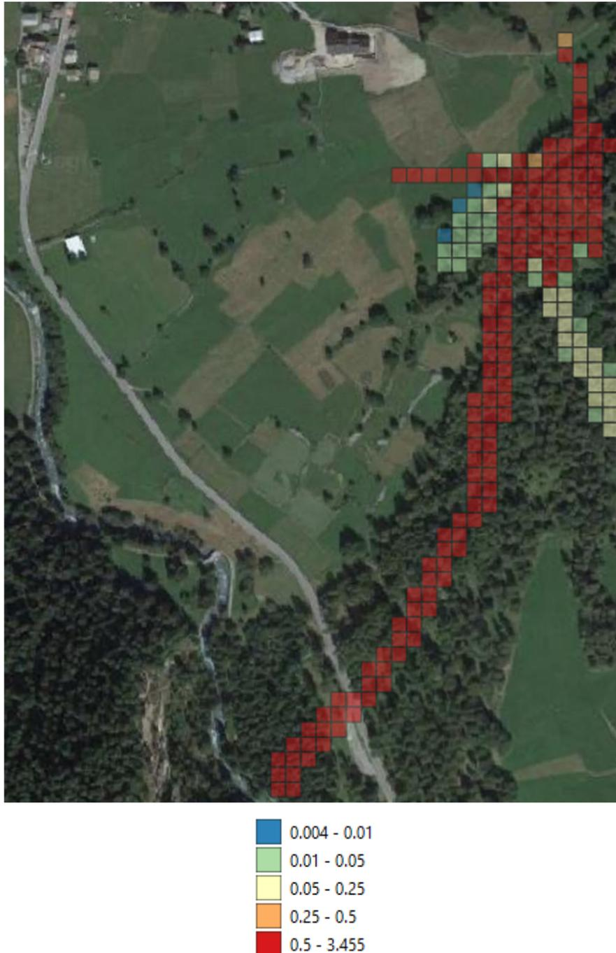
**Figura 7.6: Mappa delle altezze del flusso idrico nel canale e sul conoide a seguito dell'esondazione in corrispondenza di evento di debris flow con tempo di ritorno pari a 100 anni**
