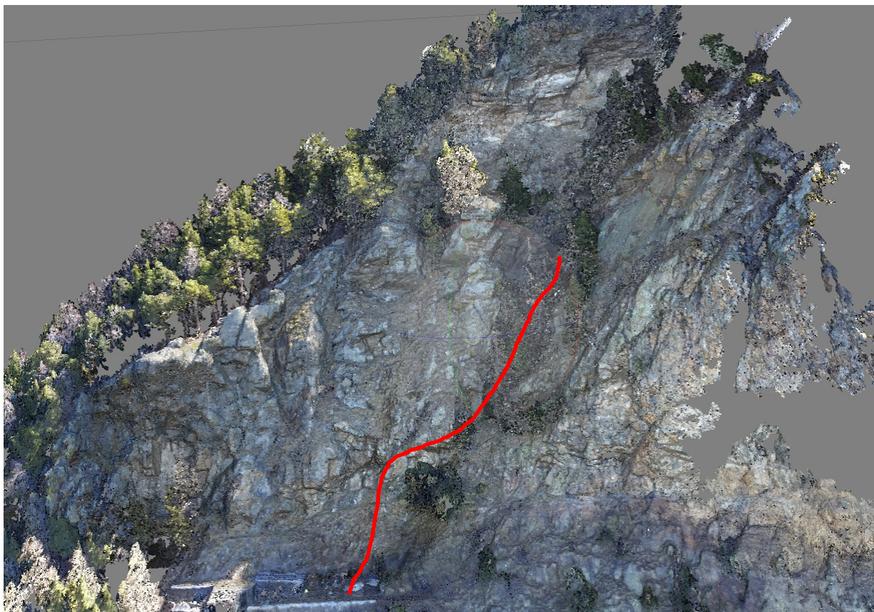
Figura 7: Nuvola di punti ottenuta dall'elaborazione fotogrammetrica. Con in rosso il percorso in progetto
